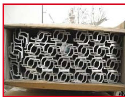
Ovim horizontalnim profilima je omogućen kontinuirani oslonac kamena, a ne ubičajeni tačkasti način fiksiranja, što dodatno daje sigurnost celom sistemu.
