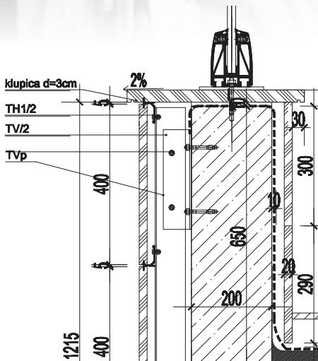
vog nosača označke TN koji daje dodatnu mogućnost udaljenja za +65mm. Novi nosači su i za fasade sa debljinom kamena 3 i više cm, jer su urađeni od specijalne legure. Ostale karakteristike u smislu mogućih načina fiksiranja su kao kod TAp nosača.
